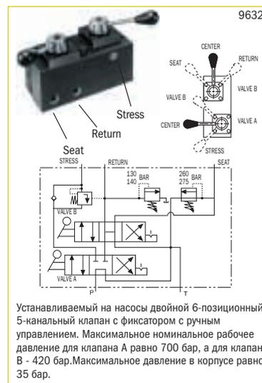
Устанавливаемый на насосы двойной 6-позиционный 5-канальный клапан с фиксатором с ручным управлением. Максимальное номинальное рабочее давление для клапана А равно 700 бар, а для клапана В - 420 бар. Максимальное давление в корпусе равно 35 бар.
