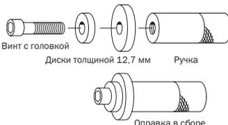
Эти комплекты включают оправку размера, подходящего для монтажа любого уплотнения, подшипника или втулки. Выбрать диски нужного размера, закрепить на ручке с помощью винтов с головкой и ударить молотком.
