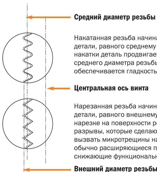
Накатанная резьба начинается с наружного диаметра детали, равного среднему диаметру резьбы. В процессе накатки деталь продвигается с диаметра, меньшего среднего диаметра резьбы, в результате чего обеспечивается гладкость и прочность резьбы.
