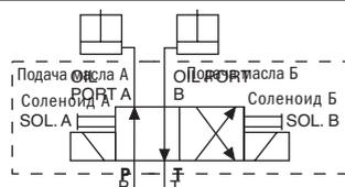
2. Чтобы активизировать Приводит в действие два цилиндра одностороннего действия
