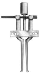
**Внутренние вспомогательные насадки** оснащены узкими лапками, которые вытягиваются вдоль центра демонируемой детали. Они обеспечивают прямое вытягивание и предотвращают повреждение корпуса детали. Внутренние вспомогательные насадки оснащены регулируемыми лапками, которые подойдут для деталей различных диаметров.
