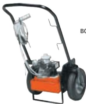
Модуль воздушного насоса с тележкой
