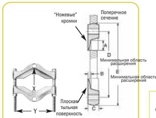
Насадка фиксируется в V-образной канавке для обеспечения равномерности распределения нагрузки. Для применения со съемниками Grip-O-Matic® или устройствами Push-Puller®.
