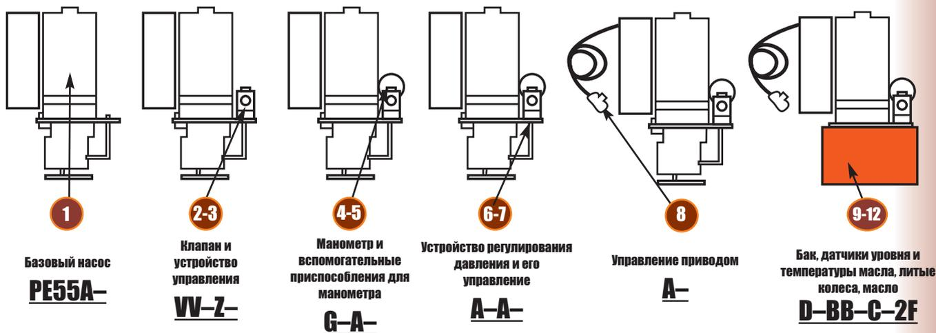
**Насос № PE55A-VV-Z-G-A-A-A-D-BB-C-2F** Насос No. PE55A-VV-Z-G-A-A-A-D-BB-C-2F представляет собой двухступенчатый насос, создающий давление 700 бар с приводом от однофазного двигателя мощностью 1,12 кВт количеством оборотов 12000 об/мин, работающий от сети с напряжением 115 В и частотой 50-60 Гц; на нем установлен 4х-канальный соленоидный клапан 9512 с устройством
