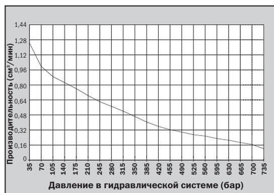
Зависимость производительности насоса PA6 от давления в гидравлической системе при давлении в пневматической системе 7 бар:
