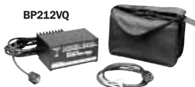
**BP212VQ** – Комплект аккумуляторный 12 В. Включает герметичный кислотный аккумулятор, зарядное устройство 115 В, провод длиной 1,2 м, переносной ящик и наплечный ремень. Вес 8 кг.
