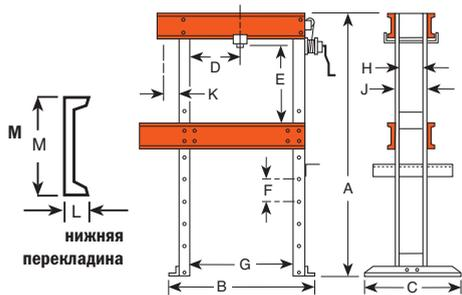
Свойства открытой горловины позволяют монтировать цилиндр на внешней стороне опоры прессы для более быстрого снятия подшипника
