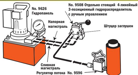
**4** Цилиндры двустороннего действия в контуре, управляемом дистанционным клапаном
