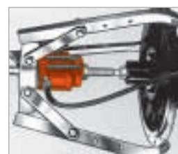
Съемник с 3 лапками обеспечивает захват детали, в то время как гидравлический привод. Насадка для вытягивания обеспечивает приложение усилия для вытягивания вала из ступицы. На конце винта съемника установлена насадка для защиты вала.
