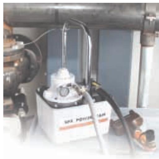
Насос PA17, подключенный к расширителю фланцевых соединений
