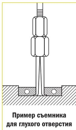
Пример съемника для глухого отверстия
