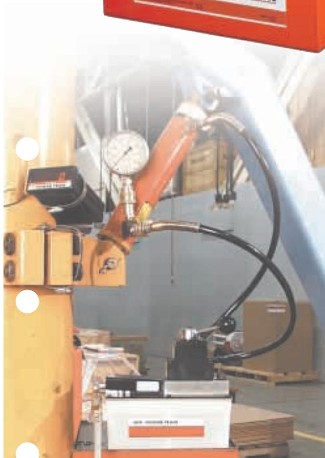
PA6D насос, DG100 цифровой манометр и 25-тонный цилиндр на стенде.
