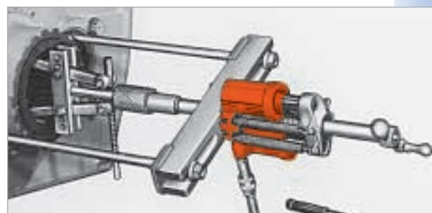
Благодаря сочетанию съемника Push-Puller® и вспомогательной насадки для выпрессовки наружного кольца подшипника значительно облегчается демонтаж уплотнения оси главной передачи.
