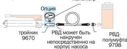
Подключение воздушного насоса
