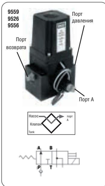
**3-х ходовой/2-х позиционный электромагнитный клапан**
