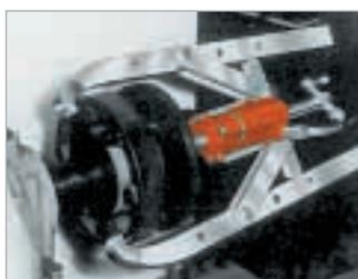
Упругая муфта демонтируется с вала электродвигателя с помощью съемника с 2 лапками.
