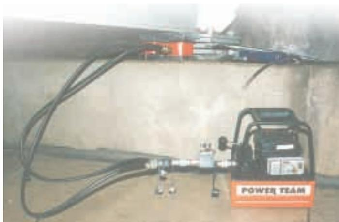
Гидравлические насосы с приводом от ДВС, как этот насос серии PG303, обеспечивают гидравлический привод оборудования, расположенного на расстоянии.
