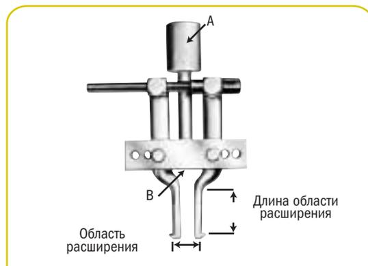
**▲ ВНИМАНИЕ** – Расчетная нагрузка этих вспомогательных насадок может оказаться меньше, чем полная нагрузка съемников, на которых они устанавливаются. Прилагаемое усилие зависит от формы и состояния демонтируемой детали, и при определенной нагрузке лапки могут сорваться. Всегда выбирайте вспомогательную насадку с самым большим показателем нагрузки для демонтируемой детали. См. стр. 193.
