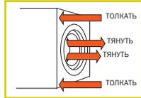
При вытягивании узких лапок внутренней вспомогательной насадки вдоль центры демонируемой детали обеспечивается прямое вытягивание и предотвращают повреждение корпуса детали. Для проблемных случаев извлечения деталей из глухих отверстий в корпусе фирма Power Team предусмотрела применение внутренней вспомогательной насадки либо комбинацию действий внутренней вспомогательной насадки и съемника.
