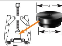
**Комплект для защиты шкива** - Защита шкива фирмы Power Team разработана для защиты центров шкива от деформации в результате приложения чрезмерного давления при работе съемников с лапками либо съемников Push-Puller®. Защита шкива вставляется между концом винта съемника и шкивом.
