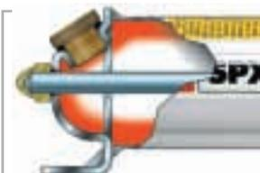
Ручные гидравлические насосы компании "Power Team" с угловыми отверстиями для заливки гидравлической жидкости оснащены защитной системой с аварийным стравливающим клапаном. Эта система предназначена для защиты бака для гидравлической жидкости от превышения в нем максимально допустимого давления при неожиданном обратном простреле давления из основной гидравлической системы. Данная система параллельно выполняет функции сальника, предотвращая протечки гидравлической жидкости.
