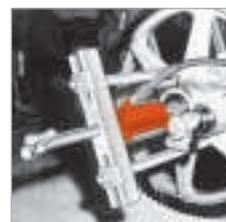
Демонтаж ведущего колеса с помощью съемника Push-Puller® с гидравлическим приводом. Насадка для вытягивания обеспечивает захват поверхности.
