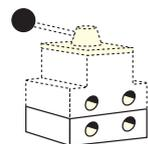
**9510 and 9620** крепятся на нижней части клапана при его дистанционной установке. **The 9515 and 9521** крепятся между крышкой насоса и клапаном.
