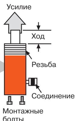
Примечание: При определении объема цилиндра двойного действия следует вычесть объем масла в штоковой полости цилиндра.
