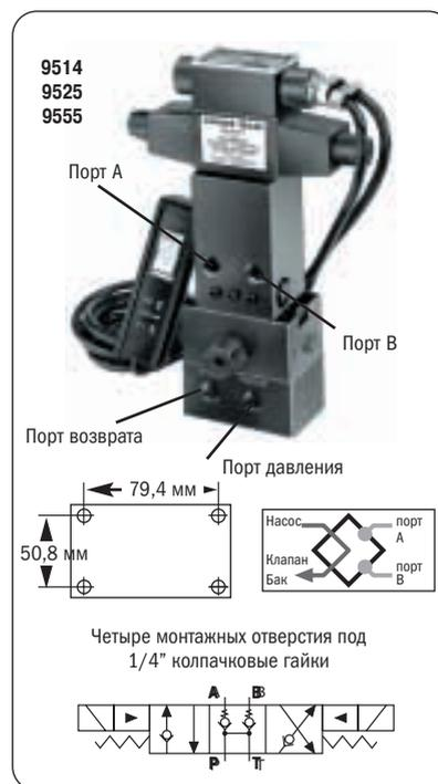
**4-х ходовой/3-х позиционный (тандемный центр) электромагнитный клапан с функцией Posi-Check®**
