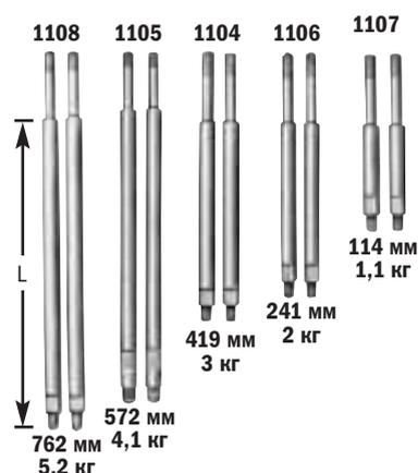
**ПРИМЕЧАНИЕ:** L = длина ножки: 114; 241; 419; 572 и 762 мм; при использовании ножек с насадками для определения длины области досягаемости нужно вычесть 124 мм из длины ножки.
