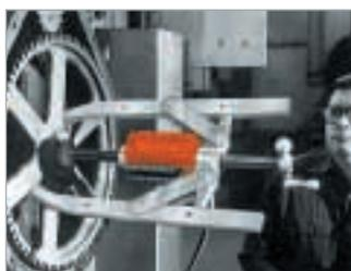
2 лапки съемника проходят между зубьями шестерни и захватывают ступицу. С помощью ручного насоса подается давление гидравлической системы.
