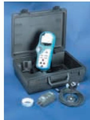
числа оборотов. Диапазон измерений - от 200 до 9999 об/мин. Точность  $\pm 25\%$ ,  $\pm 1$  об/мин. Время корректировки - 3/4 сек.
