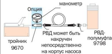
Подключение системы воздушных, электрических и газовых насосов с клапаном
