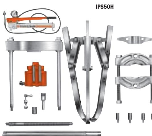
**▲ ВНИМАНИЕ:** Может оказаться, что расчетная нагрузка компонентов, приведенных в перечне, не совпадает с расчетной нагрузкой съемника. Например, если на съемнике с расчетным показателем усилия 7 тонн применяется вспомогательный компонент с пределом усилия, равным 1 тонне, все устройство будет работать с усилием только 1 т.
